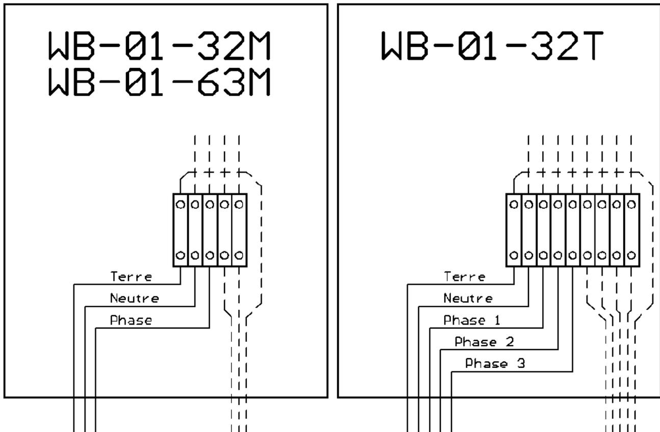
Pour faciliter le câblage de l'arrivée de puissance dans le coffret de la borne, il faut faire entrer environ 25cm de conducteurs dans le coffret et effectuer des boucles, comme sur l'image visible dans la section 2.2.
