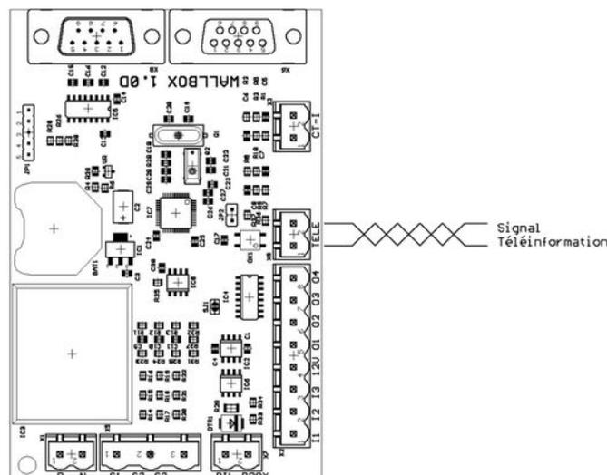
Vous pouvez utiliser du câble téléphonique ou un câble réseau informatique (dont on utilise une seule des 4 paires torsadées) pour câbler ce signal du compteur EDF à la borne. Il n'y a pas de polarité à respecter.
