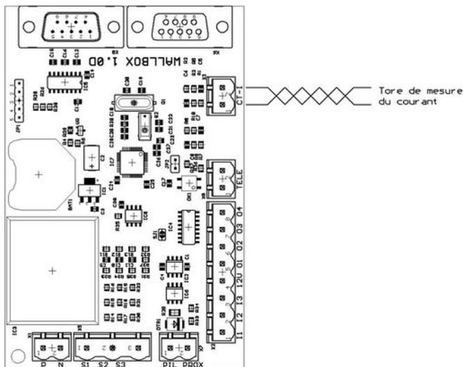
Le tore de mesure de courant doit avoir un ratio 1:1000 (nous préconisons la référence Legrand LEG412002), et doit être positionné en tête d'installation (Neutre ou Phase), afin qu'il puisse mesurer la consommation globale de l'installation.
